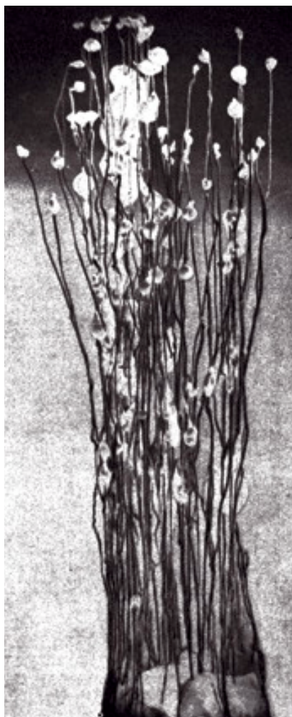
CROISSANCE OSMOTIQUE produite par Leduc à l'aide d'un mélange de chlorure de calcium et de chlorure de manganèse dans une solution de carbonates, de phosphates et de silicates.
